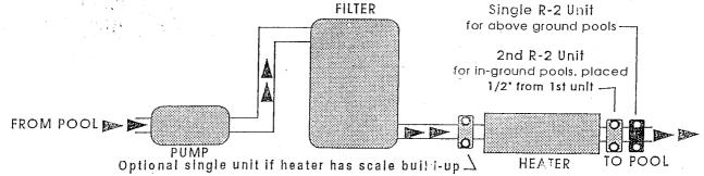
ALWAYS PLACE POOL UNIT OR UNITS ON THE RETURN LINE AFTER THE FILTER & BEFORE HEATER AS SHOWN
